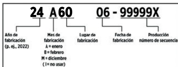
Ilustración 5-1: Placa de características con datos de fabricación
